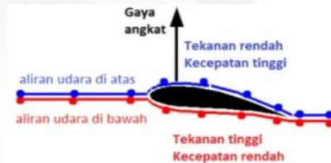
Gambar Skema gaya angkat pesawat terbang
