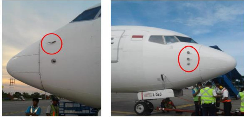
Gambar 13. Tabung pitot pada dua sisi body depan pesawat Boeing seri 737-800 Next Generation
