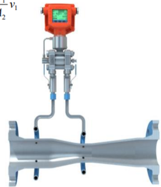
Gambar 10. Venturimeter dengan sensor tekanan
